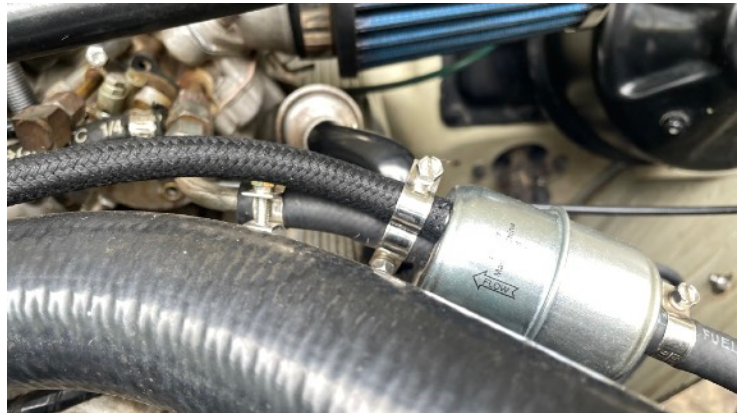
Dampfblasenabscheider mit Kraftstofffilter - Purolator F21117. Beachten: Wenig Platz zwischen den beiden Ausgängen.
